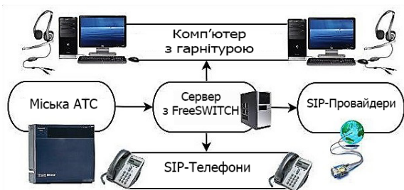
Рис. 1 Схема налаштування ір-телефонії
