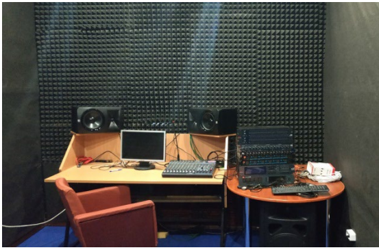
Рис.2 Заглушена кімната кафедри акустики та акустоелектроніки КПІ ім.Ігоря Сікорського для дослідження впливу складних аудіо-сигналів на електричну активність кори головного мозку людини
