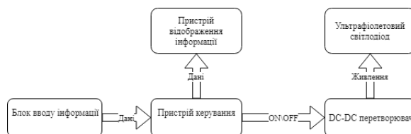
Рис. 1. Схема лабораторного приладу для експонування
